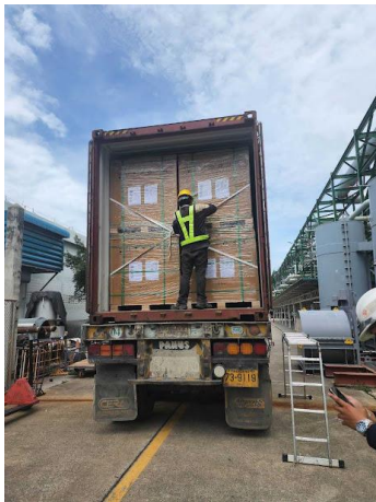
รูปที่ 3.1-5 การปิดคลุมรถยนต์อุปกรณ์ก่อสร้างด้วยผ้าใบให้มิดชิด
